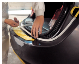
様々な形状のプレスラインに柔軟性の富んだきめの細かいスポンジと適度な粘着性を持つノリ部が作業品質の向上と効率アップに
